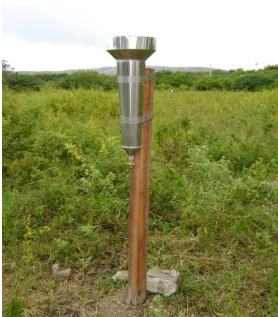
Figura 20 Pluviômetro Ville de Paris instalado em um topo de morro próximo à microbacia Natuba 3, ponto este com altimetria de 498 metros acima do nível do mar
